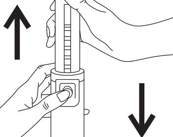
Pressione o botão de ajuste de altura para levantar ou abaixar o ventilador, conforme mostrado na figura abaixo.
