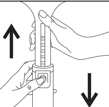
Pulse el botón de ajuste de la altura para subir o bajar el ventilador, como se muestra en la imagen.
