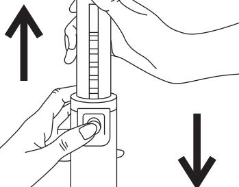
Druk op de hoogte-instelknop om de ventilator hoger of lager te zetten, zoals weergegeven in de onderstaande afbeelding.
