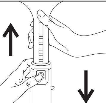
Appuyez sur le bouton de réglage de la hauteur pour monter ou baisser le ventilateur, comme indiqué sur l'image ci-dessous.
